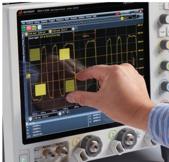
电容触摸屏和适合触摸操作的用户界面增强了示波器的可用性。
