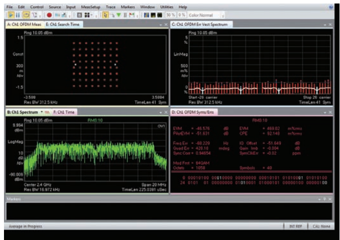
使用 V 系列采集的数据，VSA 显示了 IEEE 802.11 QAM 64 的矢量误差幅度（EVM）为 0.47%。
