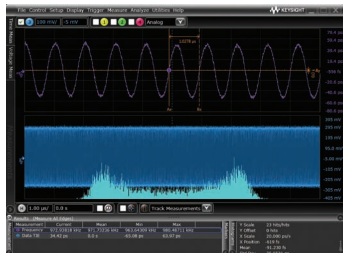
使用 Infiniium 离线软件查找信号异常，例如电源耦合。
