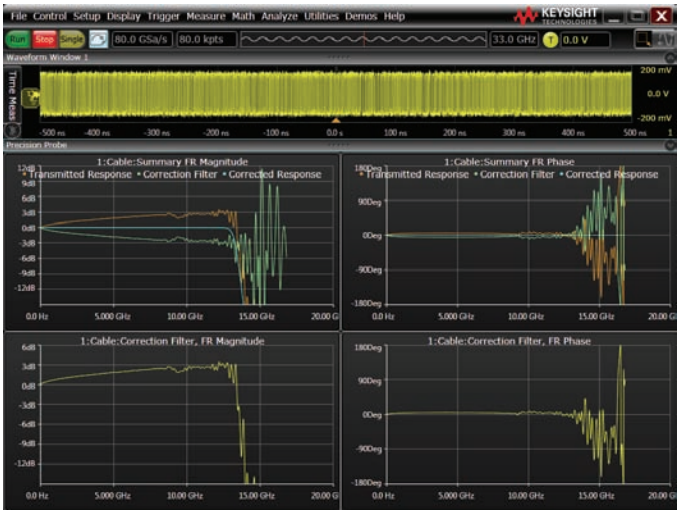
使用 PrecisionProbe 对电缆的幅度和相位响应进行校正。
