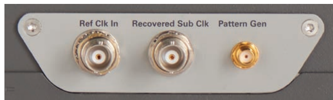
外部参考时钟输入是通过硬件串行触发来启用 SSC 跟踪的方法之一。
