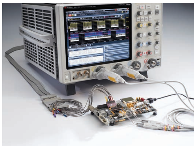
混合信号示波器的 DDR3 测试设置。
