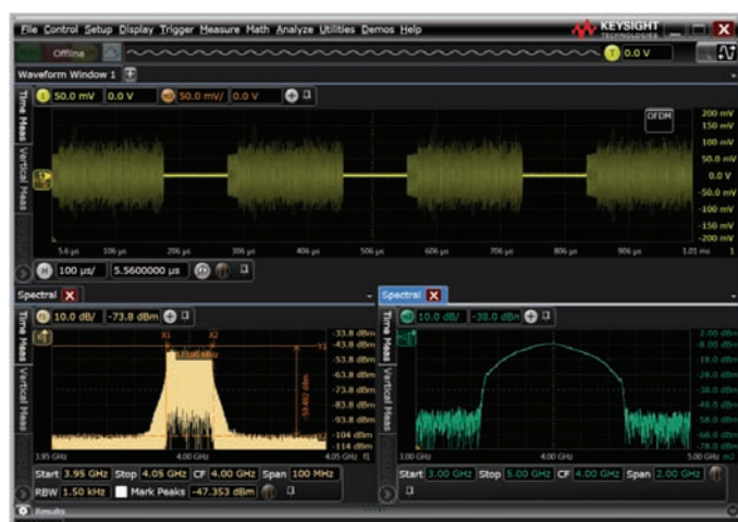
使用 Infiniium 捕获并分析 在正交频分复用 (OFDM) 实例中显示的雷达猝发信号。
